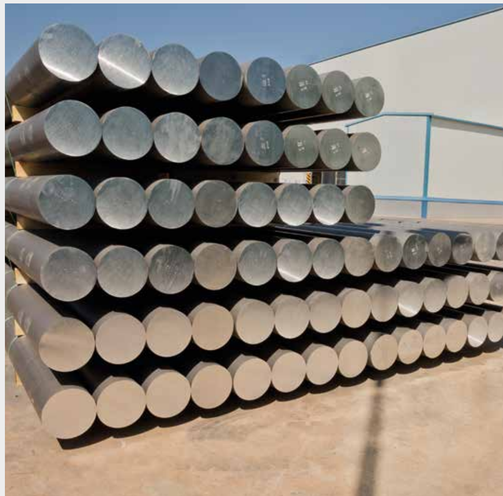
Lingotti cilindrici detti anche "billette", per ottenere profili in alluminio dritti ed eliminare ogni tensione nel materiale, vengono stirati. Vengono quindi tagliati in lunghezze adeguate e invecchiati artificialmente per ottenere la resistenza appropriata.
